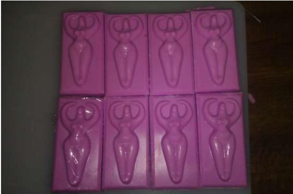
Hier werden gleich 8 Stücke auf einmal gegossen, bzw. in Schichten, weil die Schmelzkelle nicht knapp 900g Seife auf einmal verkraftet. Dann schneidet man die Stücke einfach vorsichtig auseinander.
